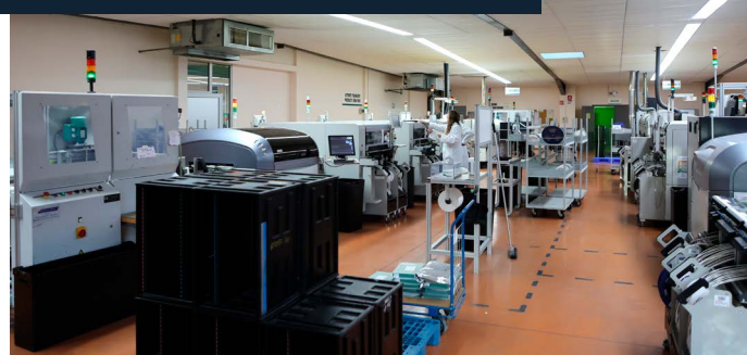
Vues des lignes de production automatisées CMS de dernière génération dédiées à la fabrication en grande série de cartes électroniques
